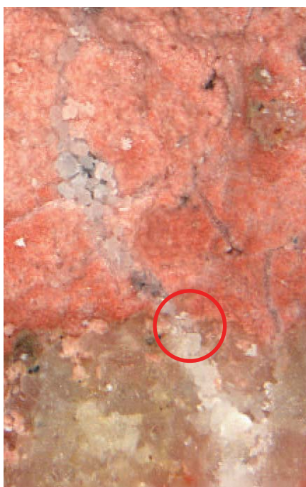
«Самозалечивание» трещин, благодаря введению продуктов серии BETOCRETE® С
